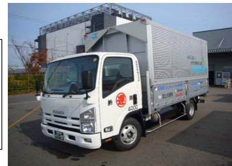
Грузовик, работающий на ДМЭ
