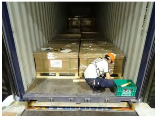
バンニング完了、根止め作業
