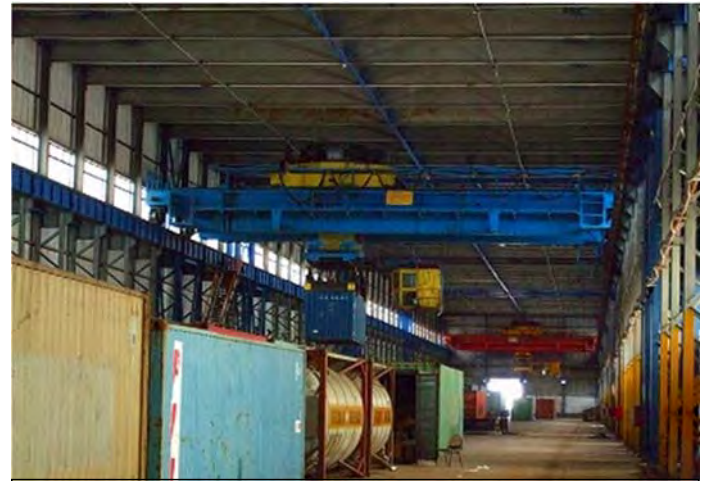
天井クレーンを使い積替え（2～3時間/列車）
