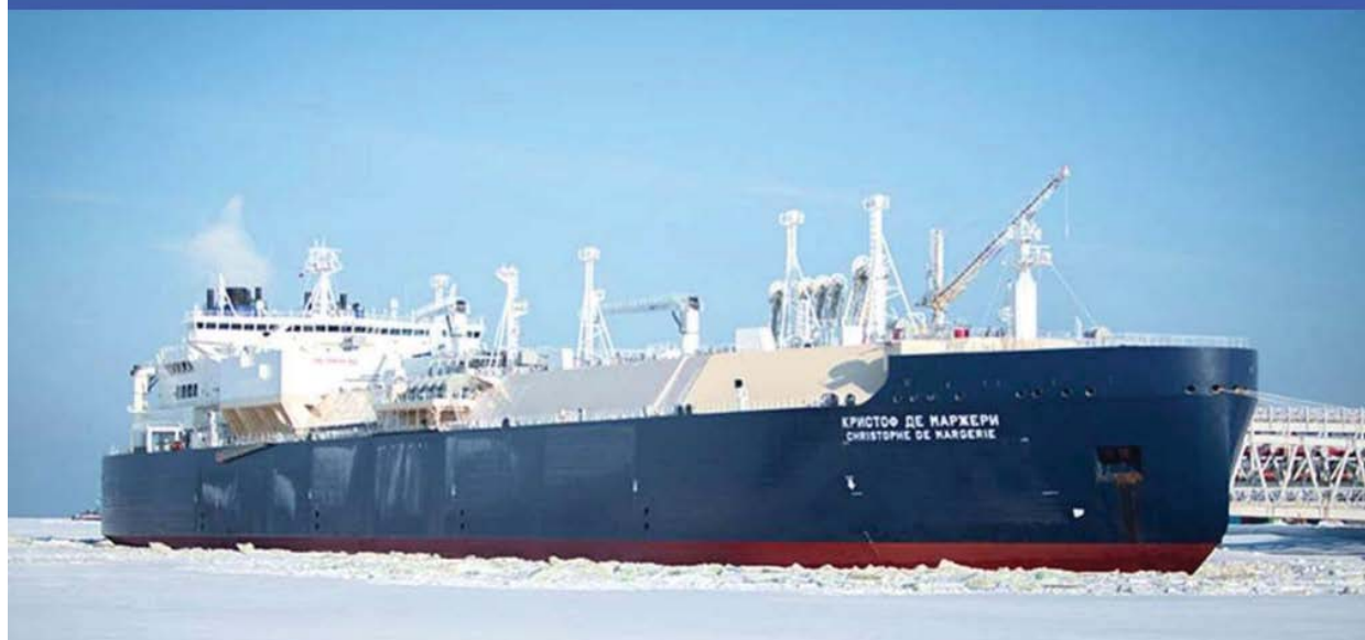
砕氷LNGタンカー Cristophe de Margerie号 (Bulbous bow球状船首がない)
