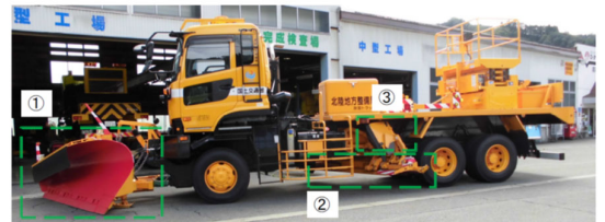
①フロントプラウ 新雪を路外に飛ばす装置 ②路面整正装置 圧雪を刺ぎ取る装置 ③サイドシャッタ 交差点等で雪を抱え込む装置
